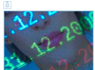
30. UV Text Geburtsdatum fluoresziert unter UV Licht über dem farbigen Gesichtsbild 30. UV text Date of birth fluoresces under UV light over the coloured facial image
